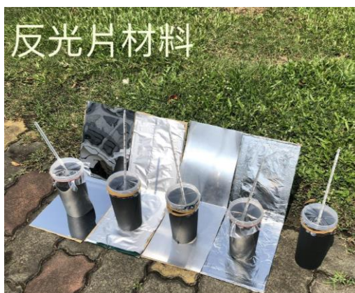
圖 4-2：貼上不同反光材料的太陽能鍋
