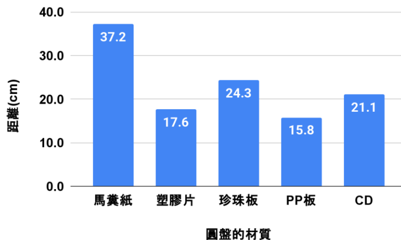
圖 5-2：不同圓盤材質的氣墊船在厚海綿軌道的行進距離長條圖
