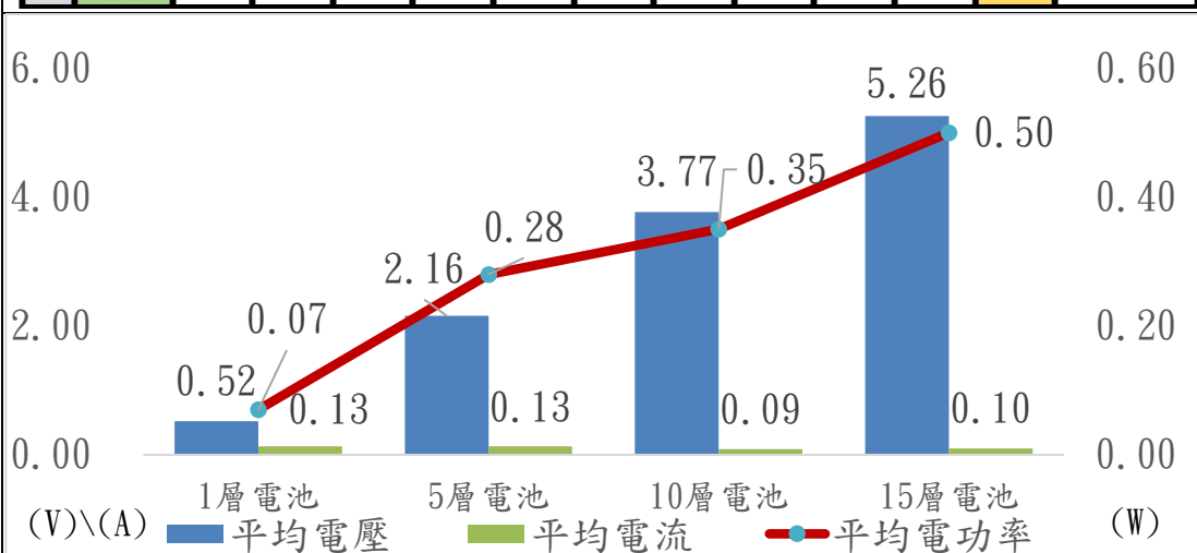
▲圖 4-3-3 飽和太白粉水中十元硬幣在不同層數電功率綜合圖
