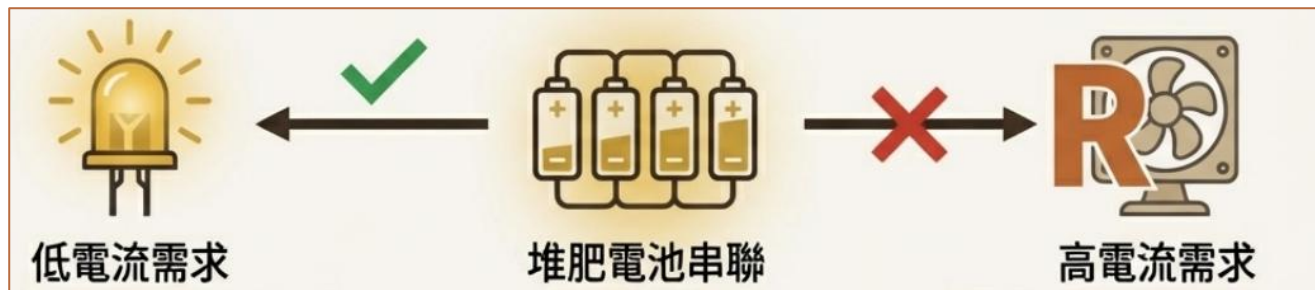
圖十 堆肥電池串聯與電流關係
