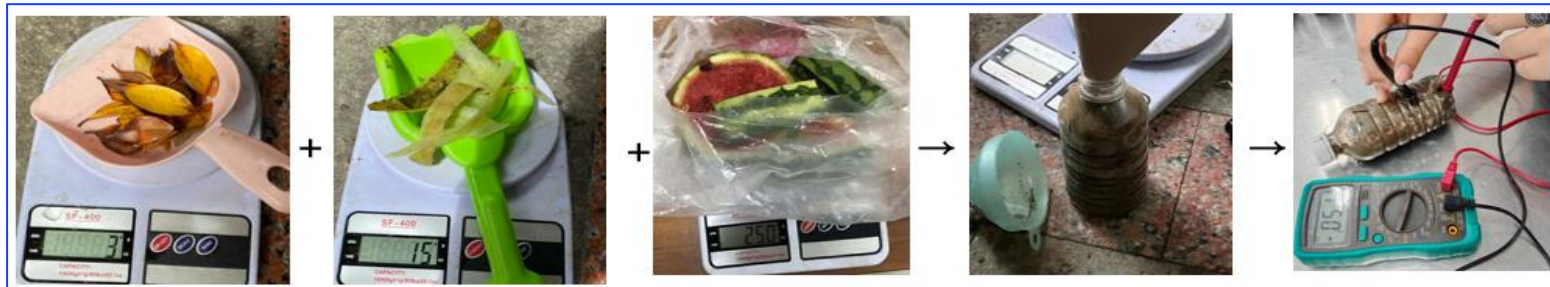
圖七(c) 自製的廚餘及落葉堆肥土壤與電壓之關係
